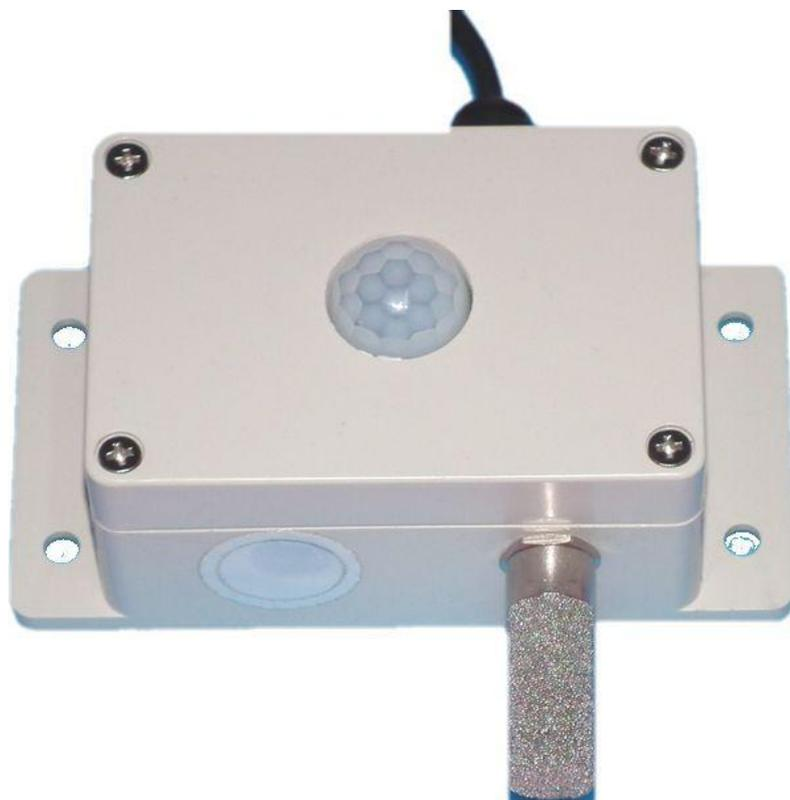
ATHLC01 RS485 二氧化碳、光照度、溫度、濕度一體感測器為 RS485 匯流排式傳感器，是針對農業生產過程中環境監測而設計的專用感測器，內置核心感測器全部為進口器件。儀器能夠連續監測二氧化碳氣體濃度、光照度及環境溫濕度等 4 種環境參數，每個參數值都轉換成MODBUS-RTU標準RS485電信號傳輸給關聯設備，本傳感器內置了警報介面，可選配超限聲光警報設備。
