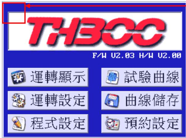
按壓左圖觸控螢幕上紅色框的位子，將會出現如下圖的密碼輸入畫面，此時只要輸入密碼後再按「ENT」鍵，即可進入系統設定的操作畫面。
