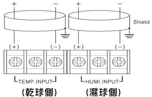
※使用電流輸入時請在輸入端子間連接 250Ω ±0.1%的電阻後再使用。
