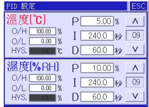
圖 22-PID 設定畫面
