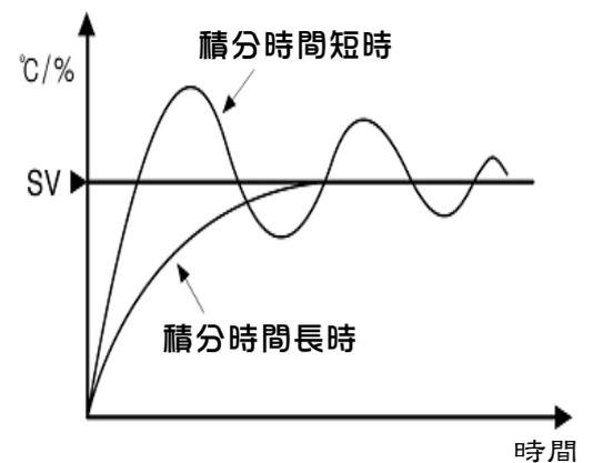
圖 27-比例積分控制(PI 控制)
