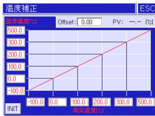
圖 3-溫度線性偏差補正畫面
