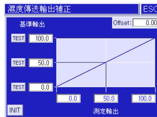
圖 12-濕度再傳送線性偏差補正畫面
