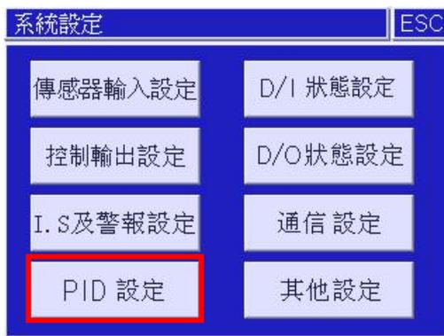
本機台之 PID 區域是由溫度側 4 個點和濕度側 4 個點所構成，共可分為 16 組 PID 區域；另外，每個區域的分割點，也可依照使用者的需求作更改。如下表所示：
