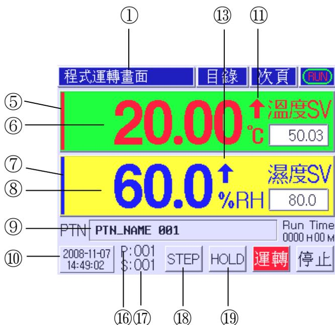
[圖 9a]程式控制啟動畫面
