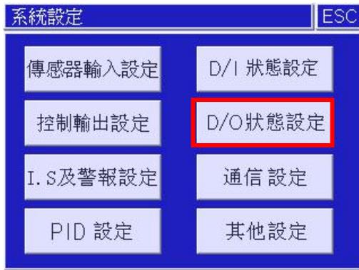
D/O 狀態設定是把系統內的各種信號分配到實際接點輸出和開路集電極輸出的畫面。在此只有被分配、連接的信號才可以通過實際端子進行輸出。接點輸出(D/O)分配除了特殊情況外也可重複分配，因此必需謹慎分配輸入接點與開路集電極。
