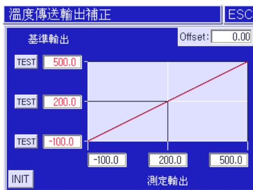
圖 11-溫度再傳送線性偏差補正畫面
