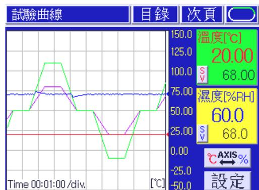
[圖 24] 程式控制試驗曲線顯示畫面
