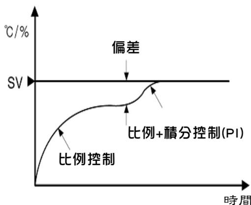
圖 26-比例控制/比例積分控制(P 控制/PI 控制)
