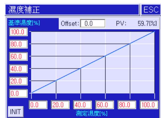
圖 4-濕度線性偏差補正畫面
