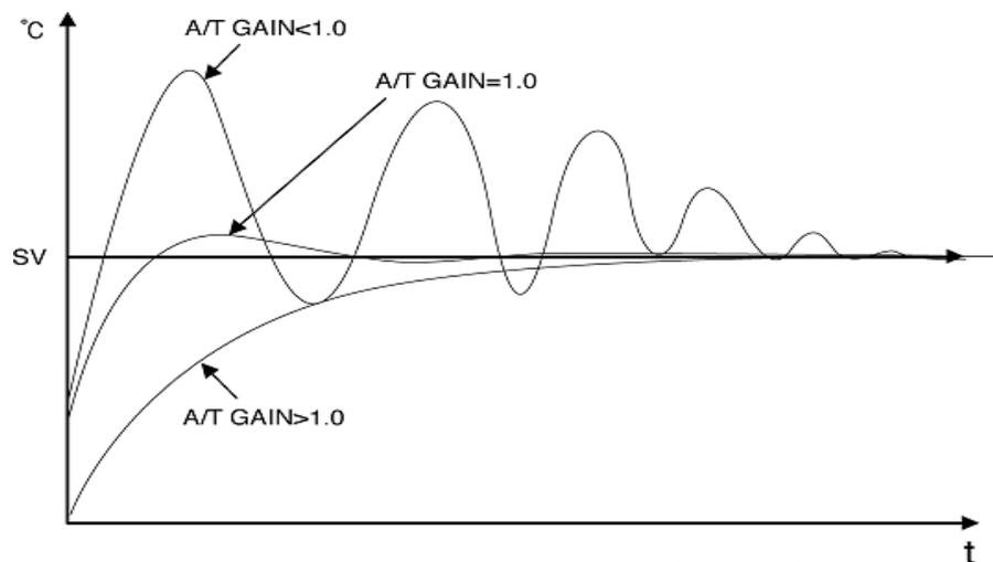
圖 23-隨 GAIN 值調節而變化(PV)的控制特性曲線
