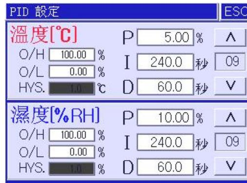
圖 22-PID 設定畫面
