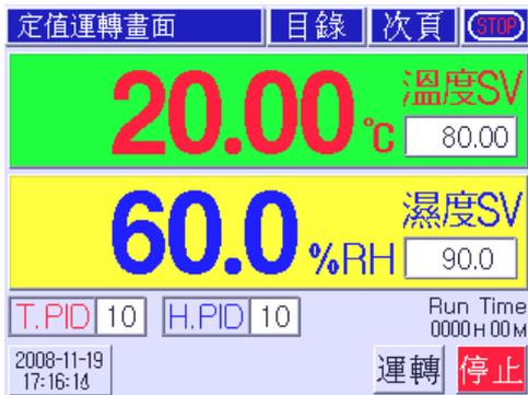
[圖 12] 定值控制第 1 停止畫面
