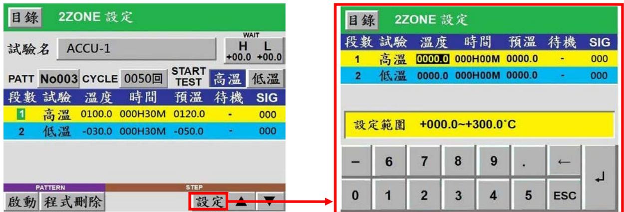
設定步驟 1：設定試驗溫度目標值，以下方鍵盤輸入數值，鍵盤上方有提示視窗輔助使用者設定。
